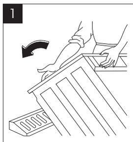
1 運送箱を完全に解いてから洗濯機を覆かして、機械の下にあるポリスチレンのベースを取り除いてください。
